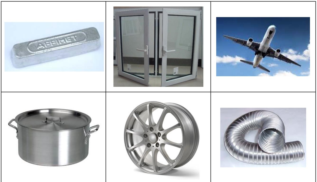
鋁元素在地殼中的含量居金屬首位，佔地殼總量的 7.57%。鋁是輕金屬，密度僅是鐵三分之一左右。純鋁較軟，在 300°C 左右失去抗張強度，熔點 660.4 度。經處理過的鋁合金，質輕而較堅韌。
