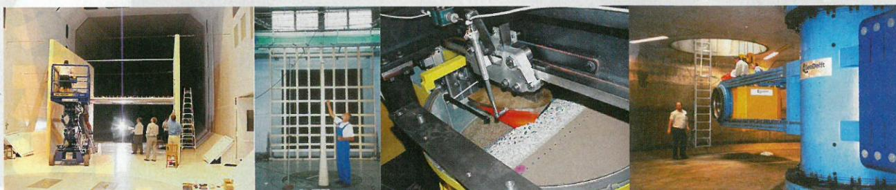
● 在工程學上，興建昂船洲大橋是一項新挑戰，所以工程師在設計橋身時進行了大量模型測試，包括：風洞測試、防撞測試，務求使昂船洲大橋落成後有足夠能力，抵禦十級颱風和最惡劣的環境。
