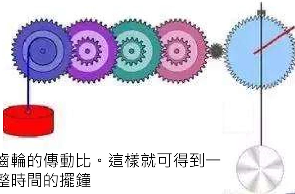
利用齒輪的傳動比。這樣就可得到一個完整時間的擺鐘
